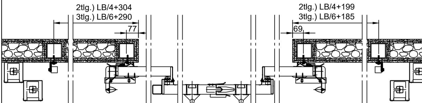
Das Tor muss an mindestens EI30 verkleidete Stahlträger montiert werden. Die Stahlträger müssen von allen Seiten geschützt sein. Zwischen den geschützten Stahlträgern kann eine Trockenbauwand gesetzt werden.
