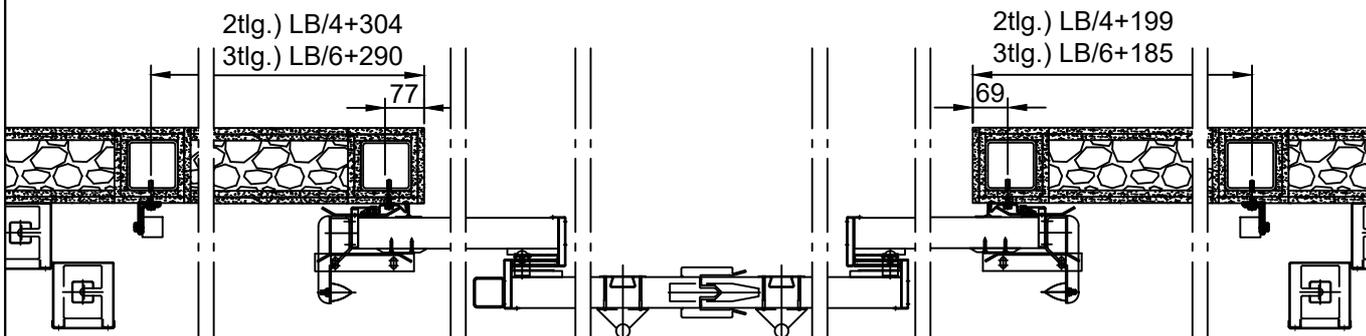
Das Tor muss an mindestens EI90 verkleidete Stahlträger montiert werden. Die Stahlträger müssen von allen Seiten geschützt sein. Zwischen den geschützten Stahlträgern kann eine Trockenbauwand gesetzt werden.
