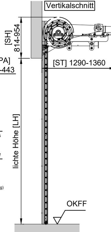
Vertikalschnitt - Deckenmontage
