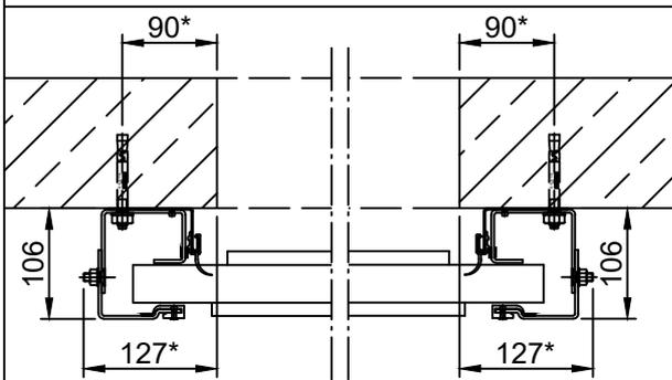
\* Bei Porenbeton +10mm
