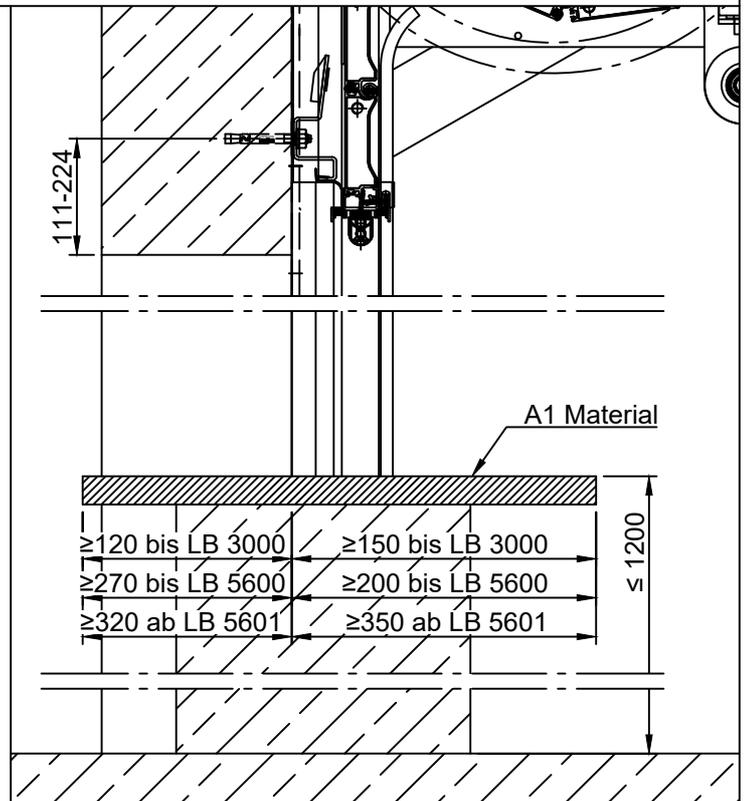
\* Bei Porenbeton +10mm
