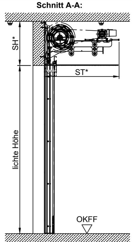
\* Durch die Vergrößerung der Überdeckung, ist bei dem Ablesen der Werte aus Anlage 1.8 die lichte Breite 60mm breiter und die lichte Höhe 40mm höher anzunehmen!
