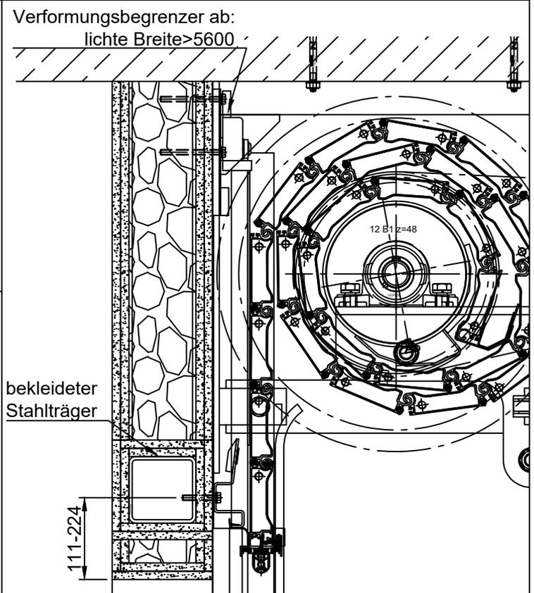
Die gesamte Unterkonstruktion (Rohre und Montagekonsolen) müssen vollständig mit einer EI30-Beklankung geschützt werden. Zwischen der geschützten Unterkonstruktion und nebenliegenden Wänden kann eine Trockenbauwand gesetzt werden.
