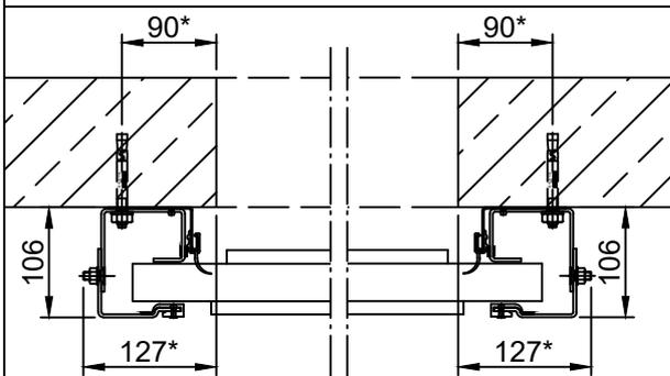
\* Bei Porenbeton +10mm
