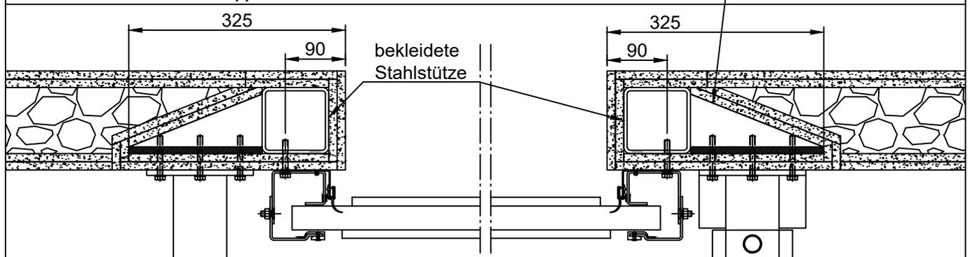
Die gesamte Unterkonstruktion (Rohre und Montagekonsolen) müssen vollständig mit einer EI30-Bepankung geschützt werden. Zwischen der geschützten Unterkonstruktion und nebenliegenden Wänden kann eine Trockenbauwand gesetzt werden.
